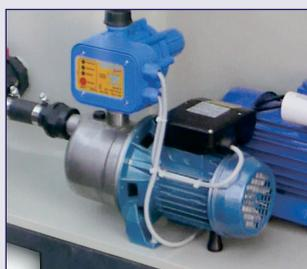
Druckerhöhungs-Einheit mit Trockenlaufschutz
